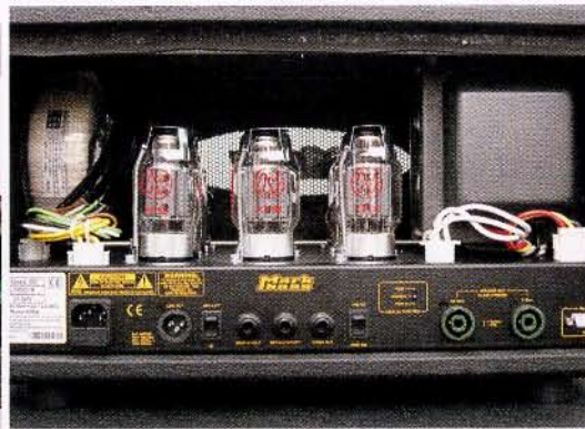
Der mächtige Schnittbandkern-Ausgangsübertrager trägt zum druckvollen Sound bei.
